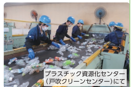
プラスチック資源化センター (戸吹クリーンセンター)にて 手選別で混入物等を徹底的に取り除き、 品質の良いリサイクル原料に
