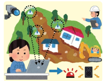
現場の土砂等の変異を感知し、音と光で警報を発報する傾斜警報監視システム
