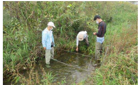
浅川右岸平岡町排水樋管出口部流れ 流量測定中
