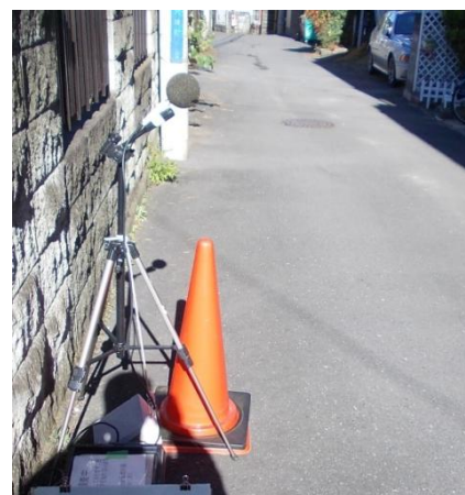
道路交通騒音測定
