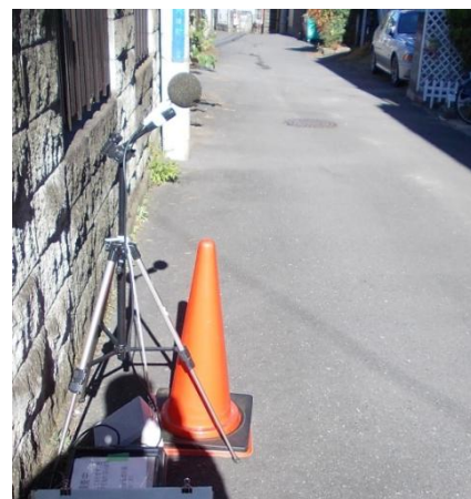
道路交通騒音測定
