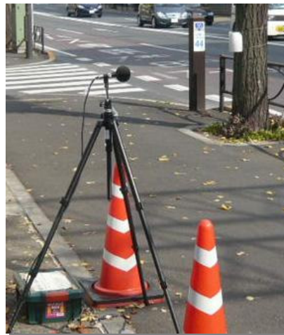
道路交通騒音測定
