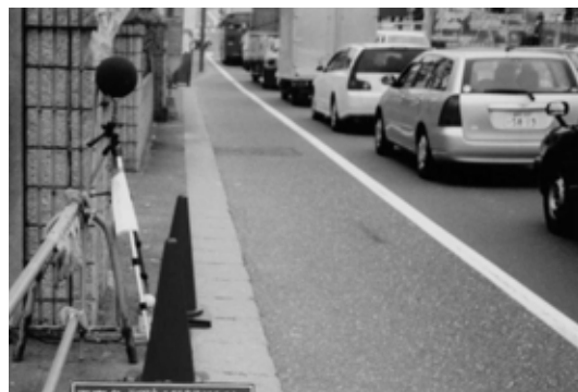
道路交通騒音測定
