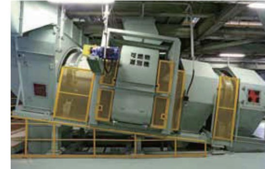
可燃物選別機 袋と内容物が分離されたごみの中から、可燃系ごみと不燃系ごみに選別し、手選別にかかる負担を軽減します。
