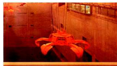
ごみクレーン
