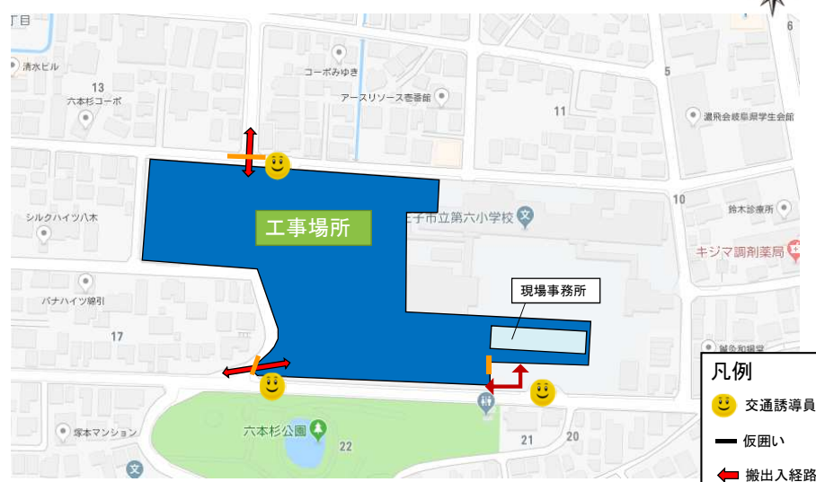
工事車両搬出入経路図（拡大図）
