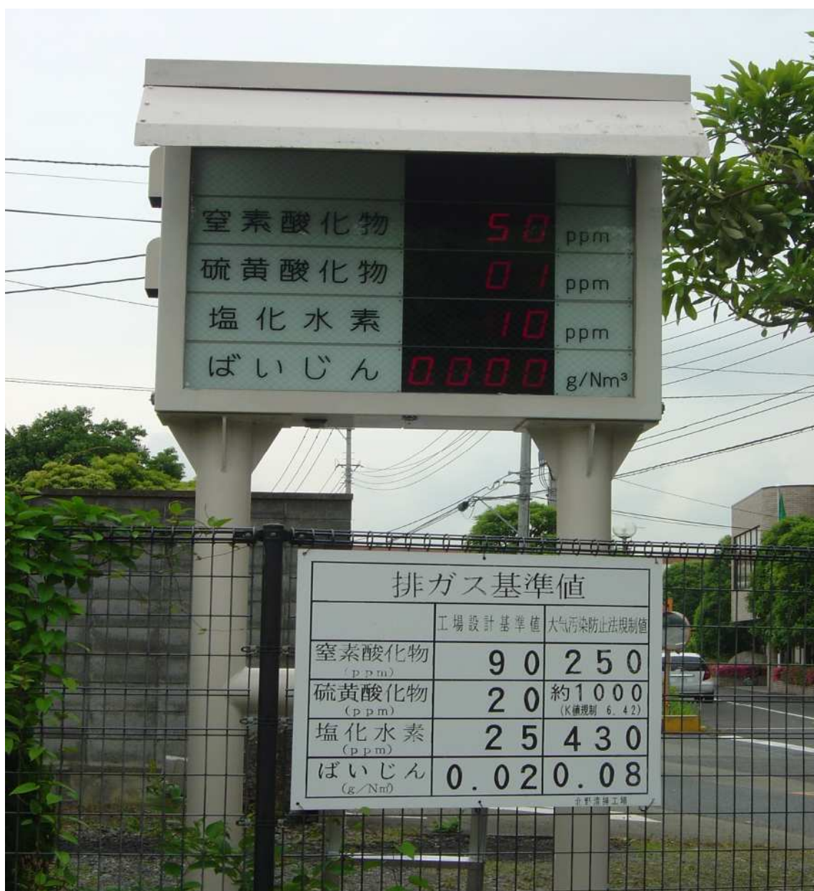
「排ガス状況表示盤」
