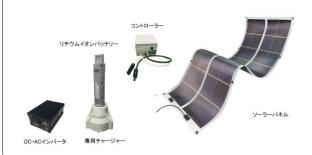
厚さ 1 mmの柔軟なソーラーパネルで発電し、脱着可能リチウムイオンバッテリーに蓄電し、DC-AC インバータを介して出力することができるポータブル電源。独自の特許技術によりコントローラーを超軽量化できたことで、総重量を大幅に軽減。災害時などでも場所を選ばず電気を供給することができる。
