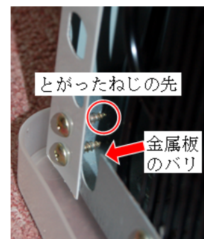
背面にある危険な箇所
