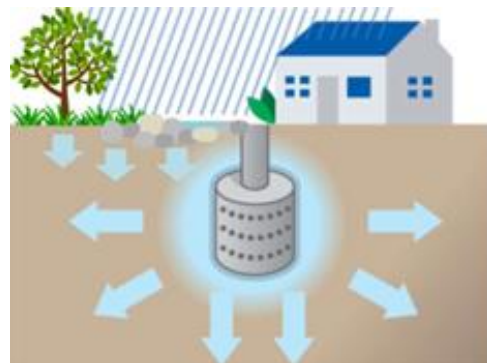
緑化等を伴う雨水浸透施設
