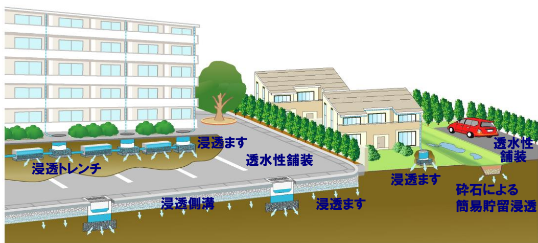
図4-3 雨水浸透施設の設置のイメージ
