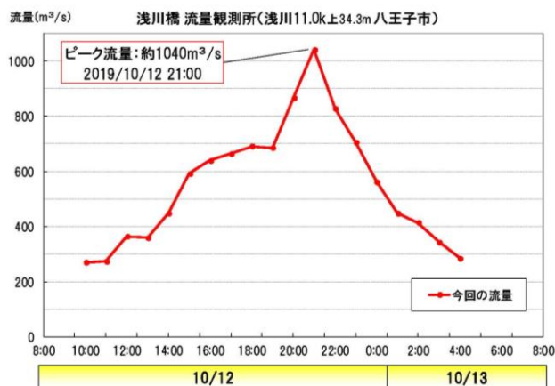
図1-2 令和元年（2019年）台風19号の降雨による、浅川橋での水量の変化 出展：出水概要（京浜河川事務所）
