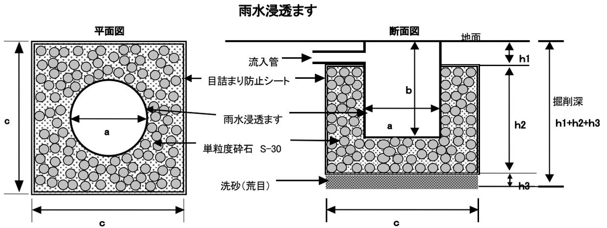
※浸透ますは底面及び側面から浸透する構造とする。
