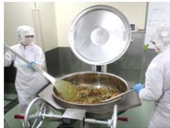
茹でた野菜を真空冷却器で冷却し、和え物室で手作りドレッシングと和えて配缶し、冷蔵庫で保管します。
