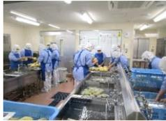
野菜や果物を3回洗浄するため、3槽の流しが4台あります。処理し終わった野菜は、隣の煮炊き室へ窓から渡します。果物の洗浄には、微酸性電解水を使用し、表面を殺菌・消毒します。
