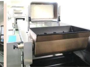
米庫から一釜ずつ米が送り込まれ、自動洗米し、設定した水とともに炊飯釜に入れます。ガス炊飯し、最後はふっくらとごはんをほぐす機械を通り、配缶します。
