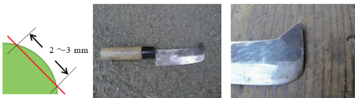
図 1 メカイ包丁。先の上は「ツノ（角）」、下は丸みを帯びている。
