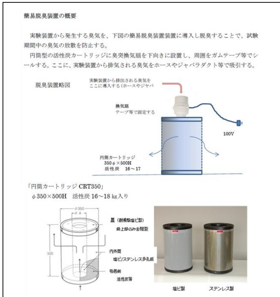
図Ⅱ-1-6 簡易脱臭装置
