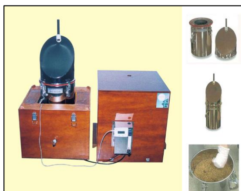
図Ⅱ-1-5 小型堆肥化実験装置(通称：かぐやひめ)
