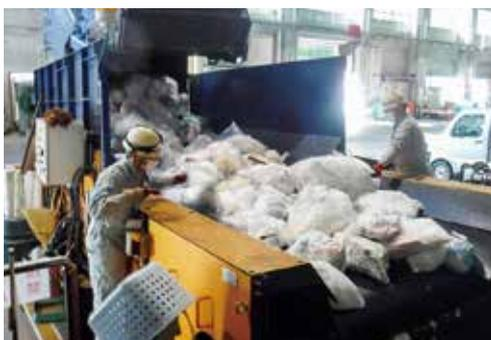
▲検査機による搬入ごみ検査のようす
