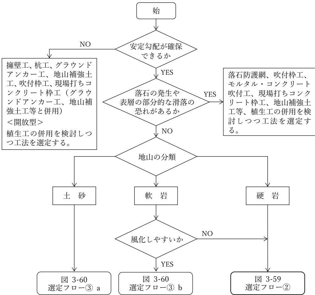
図 3-58 法面保護工の選定フロー① (切土法面の場合)
