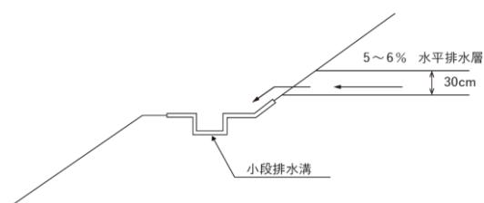
図 3-73 水平排水層端部
