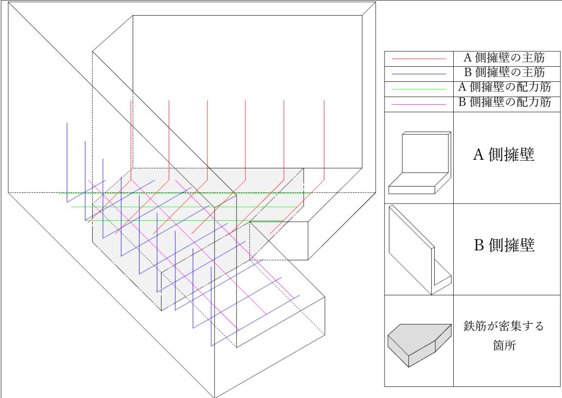
図 3-26 鉄筋コンクリート造擁壁の隅部が鋭角時の配筋図
