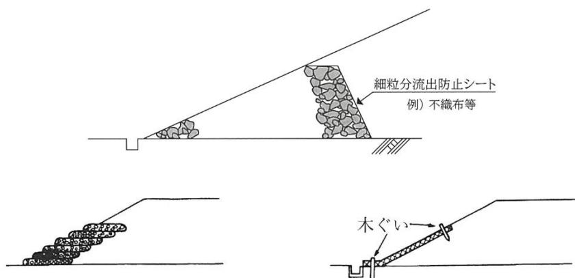
図 3-72 法尻工の例[引用]道路土工 盛土工指針
