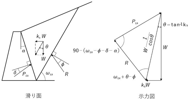
図 3-35 地震時主働土圧の考え方
