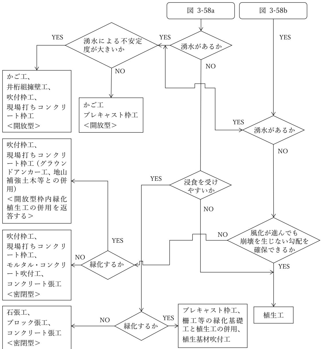
図 3-60 法面保護工の選定フロー③（切土法面の場合）
