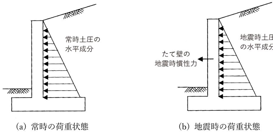
図 3-41 豊壁の断面計算における荷重状態
