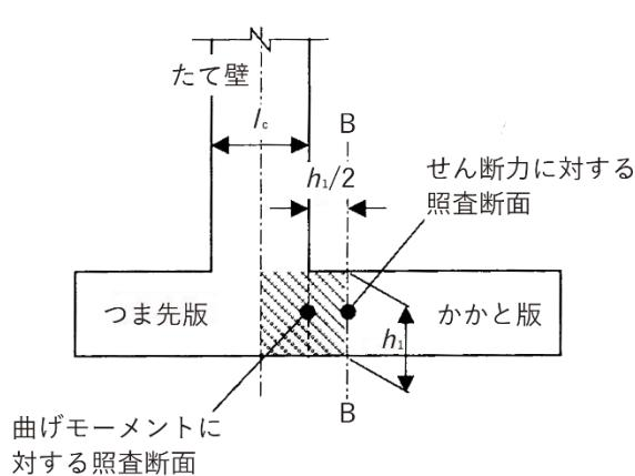
図 3-45 かかと版のせん断力を照査する断面
