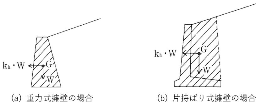
図 3-37 地震時慣性力の考え方
