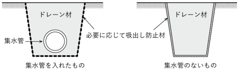
図 3-69 地下排水工の断面
