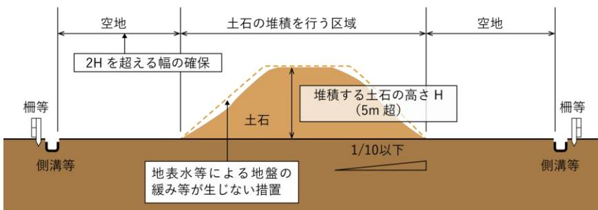
図 3-77 堆積する土地の基準（高さ 5m 超）
