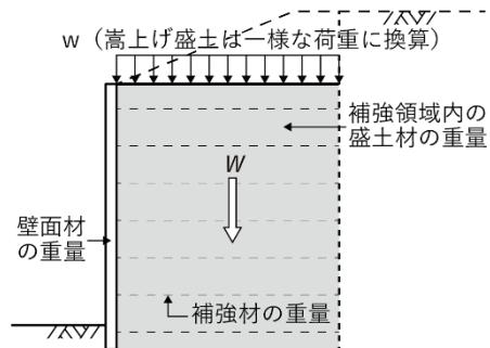
図 3-50 補強土壁の自重の考え方（部材の安全性の照査時）
