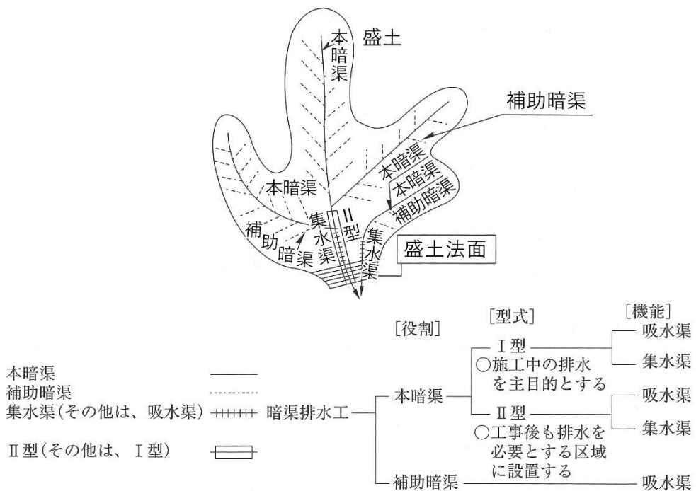
図 3-70 地下水排水工の配置
