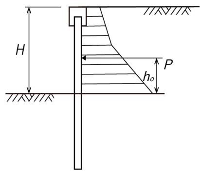
図 3-83 鋼矢板擁壁に作用する土圧及び水圧
