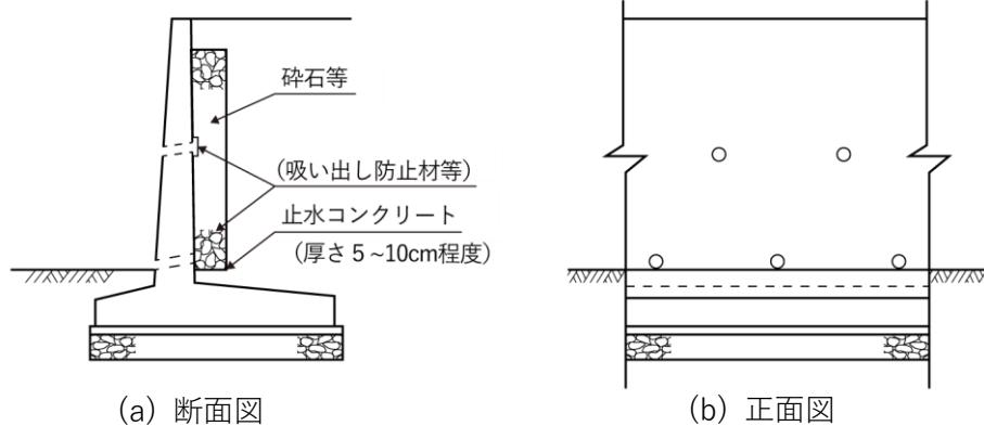
図 3-27 鉄筋コンクリート擁壁の断面図及び水抜穴設置図
