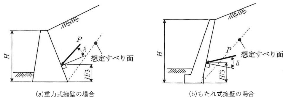
図 3-31 土圧作用面（重力式擁壁等）
