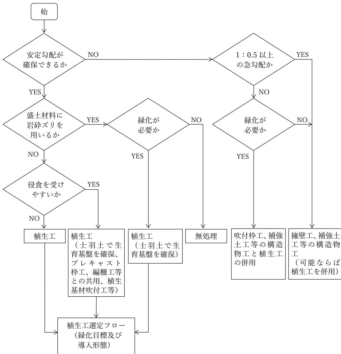
図 3-57 法面保護工選定フロー（盛土法面の場合）
