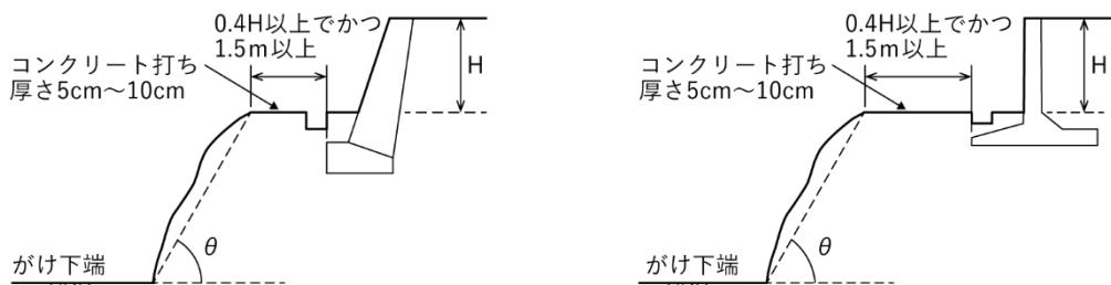
図 3-15 斜面の擁壁の構造
