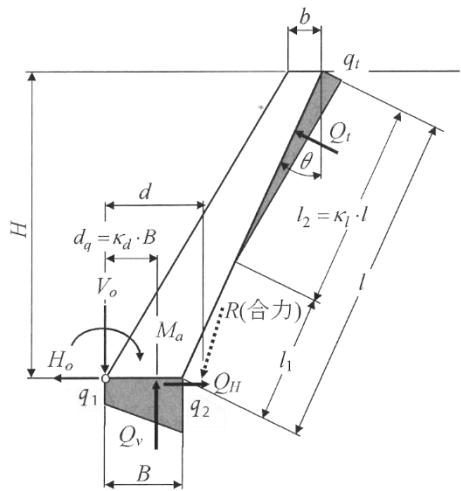
図 3-40 地盤反力係数法（簡便法）
