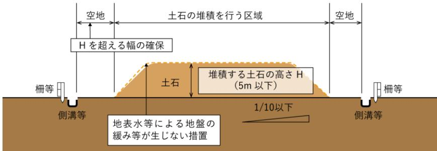
図 3-76 堆積する土地の基準（高さ 5m 以下）
