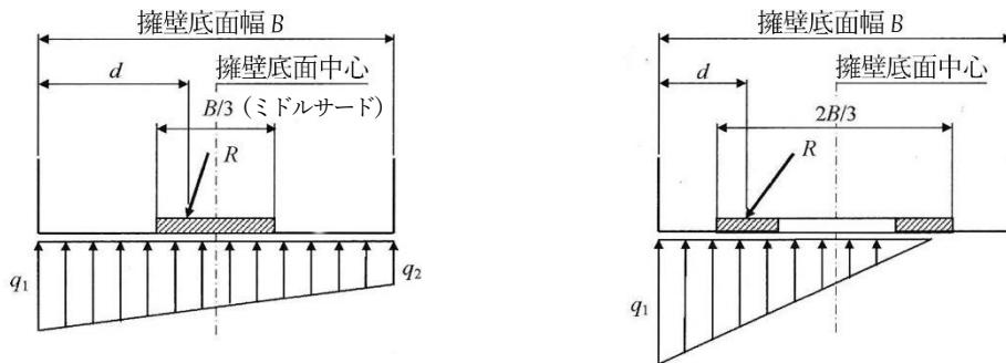
(a)荷重の合力  $R$  の作用位置が擁壁底面幅
