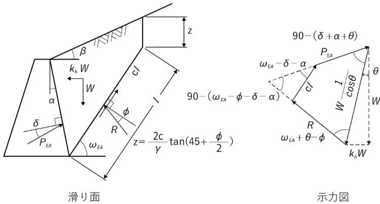
図 3-36 裏込め土が粘着力を有する場合の地震時主働土圧
