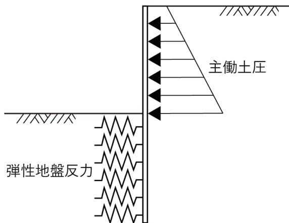
図 3-82 簡便法の計算モデル (Chang の式による)
