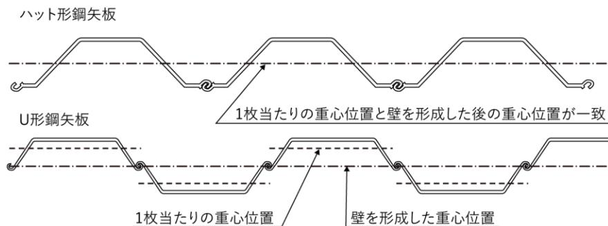
図 3-81 鋼矢板の単体と壁体の重心位置の関係
