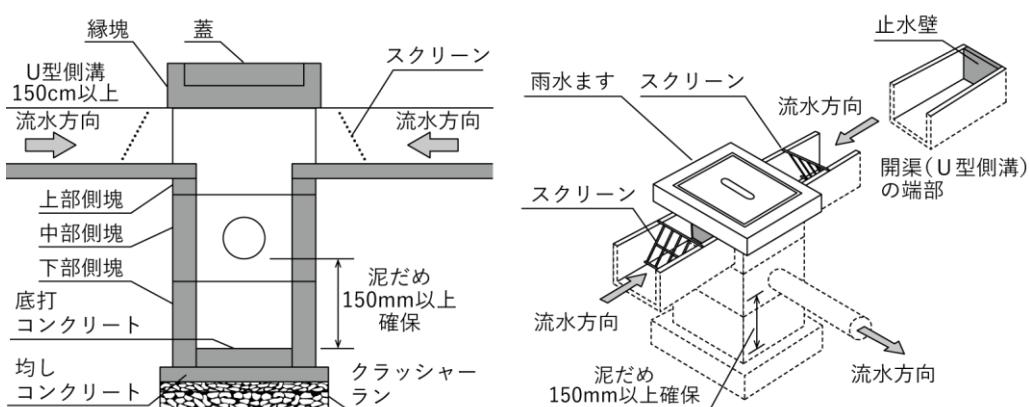
図 3-62 排水工の標準構造図
