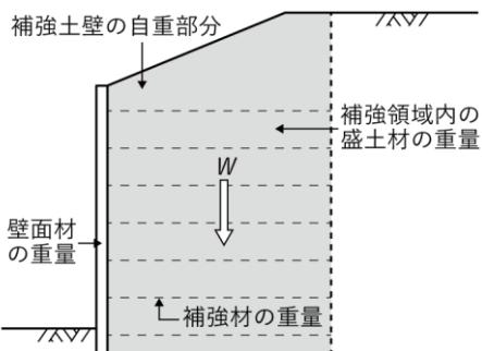
図 3-49 補強土壁の自重の考え方（安定性の照査時）
