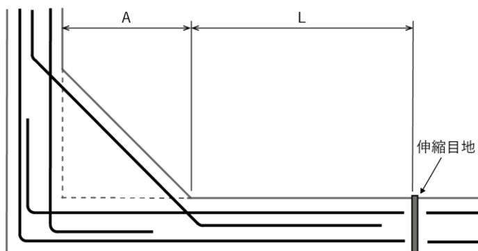
図 3-24 鉄筋コンクリート造擁壁等の伸縮目地及び隅角部の補強位置②
