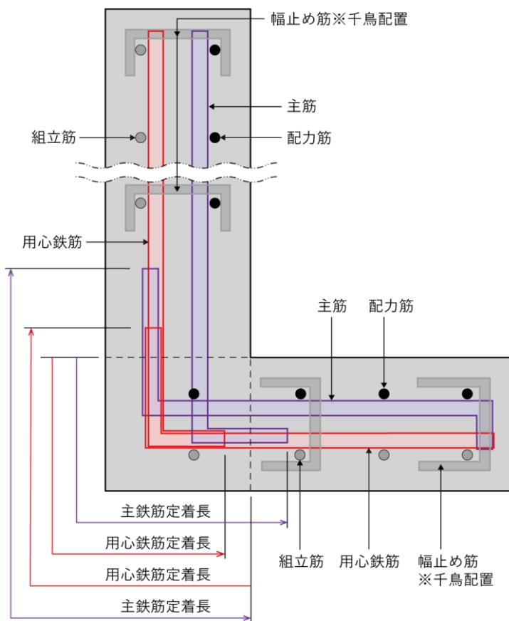
図 3-29 L型鉄筋コンクリート擁壁縦壁基部の配筋要領
