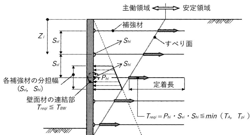
図 3-54 補強材に作用する引張力の考え方
