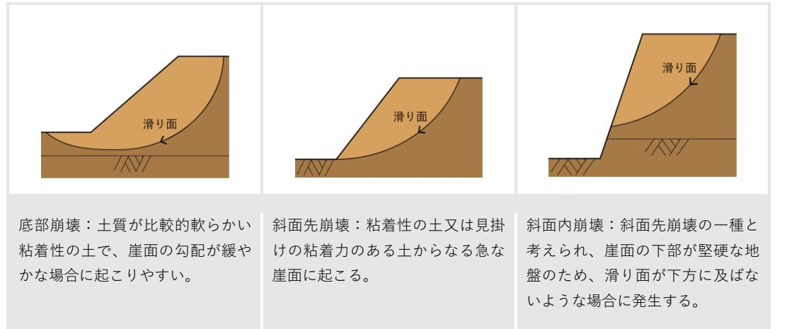
図 3-8 斜面崩壊の種類
