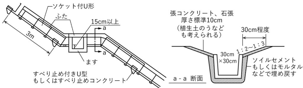
図 3-67 U型による縦排水工の構造図
