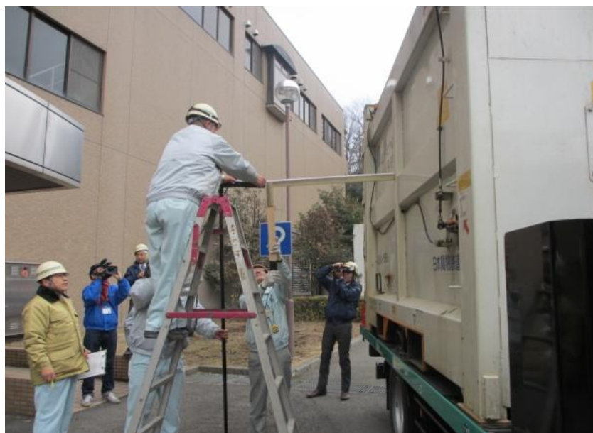
コンテナ側面の放射線量率測定
