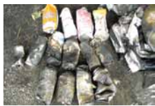
◀焼け跡から出てきたカセットボンベ
