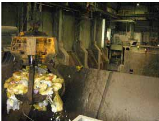
供給クレーン (フロー図 No.1)
