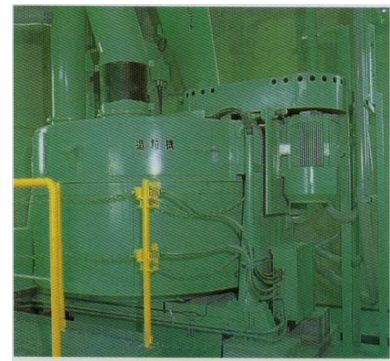
集じん灰固化装置 ろ過式集じん機で取り除いたばいじんを、薬剤処理で固めます。
