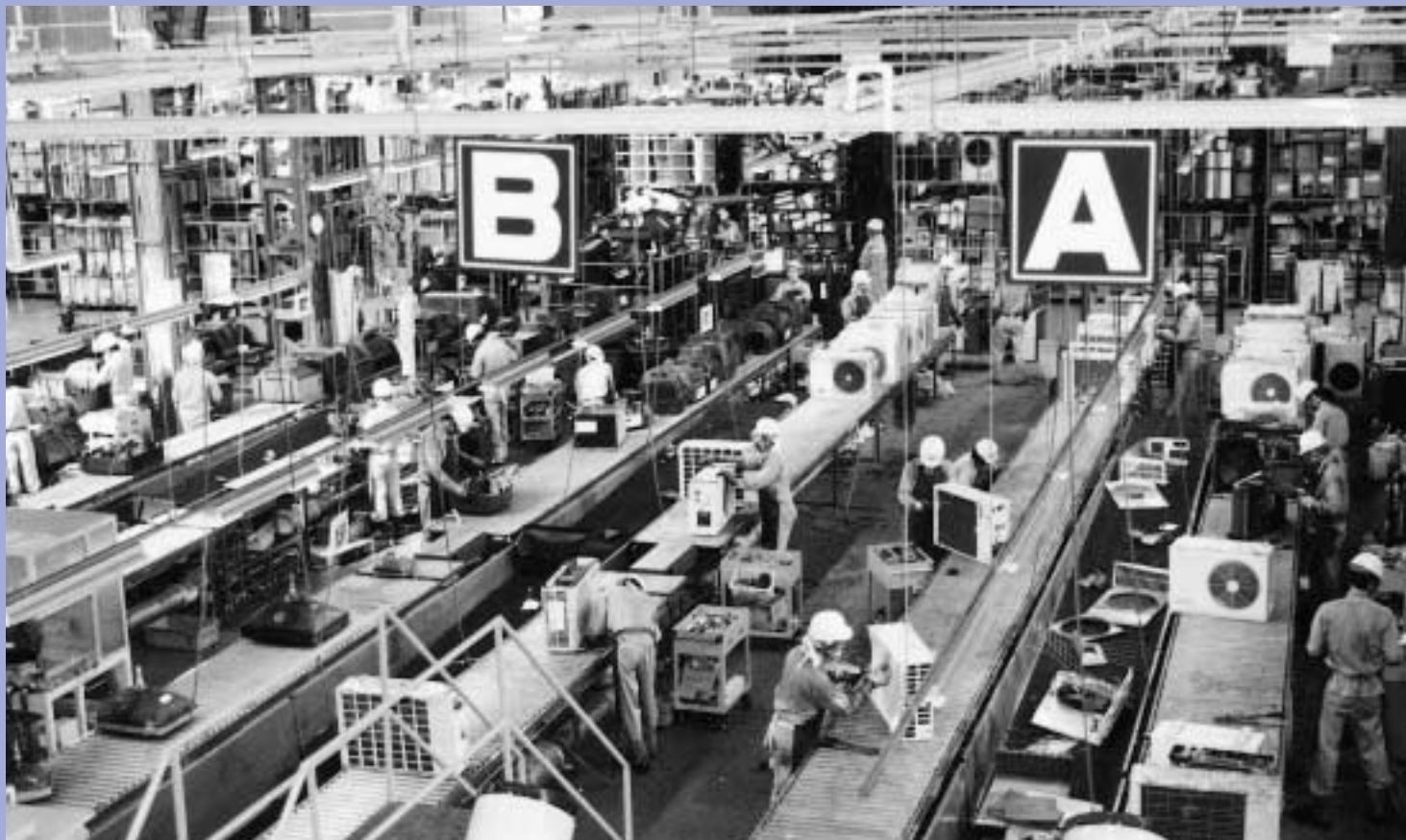
家電のリサイクル工場のような様子。テレビとエアコンが分解されています。
