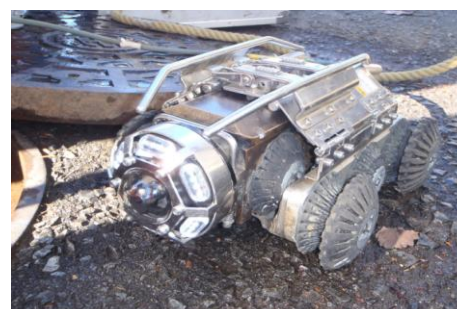
下水道管内部を調査するTVカメラ搭載車
