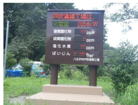
排ガス状況表示盤
